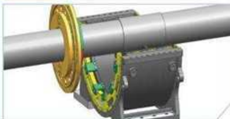
步骤二 Step 2 电机下半部分吊装 Mount the lower half of the motor
